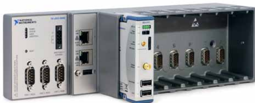
Figur 2: Den nya plattformen för byggnadsövervakning från S.E.A. Datentechnik GmbH har möjliggjorts av det Linuxbaserade realtidsoperativsystemet i den nya mjukvarubaserade styrenheten cRIO-9068.
