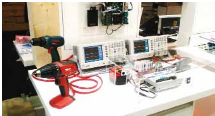
Praktisk mätupställning med demonstratorn i form av en batteridrivna skruvdragare.
