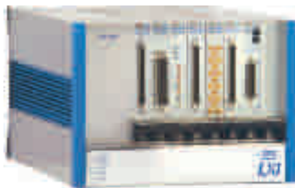
60–100 är ett PXI-chassi från Pickering Interfaces som kan anslutas till LXI-bussen.
